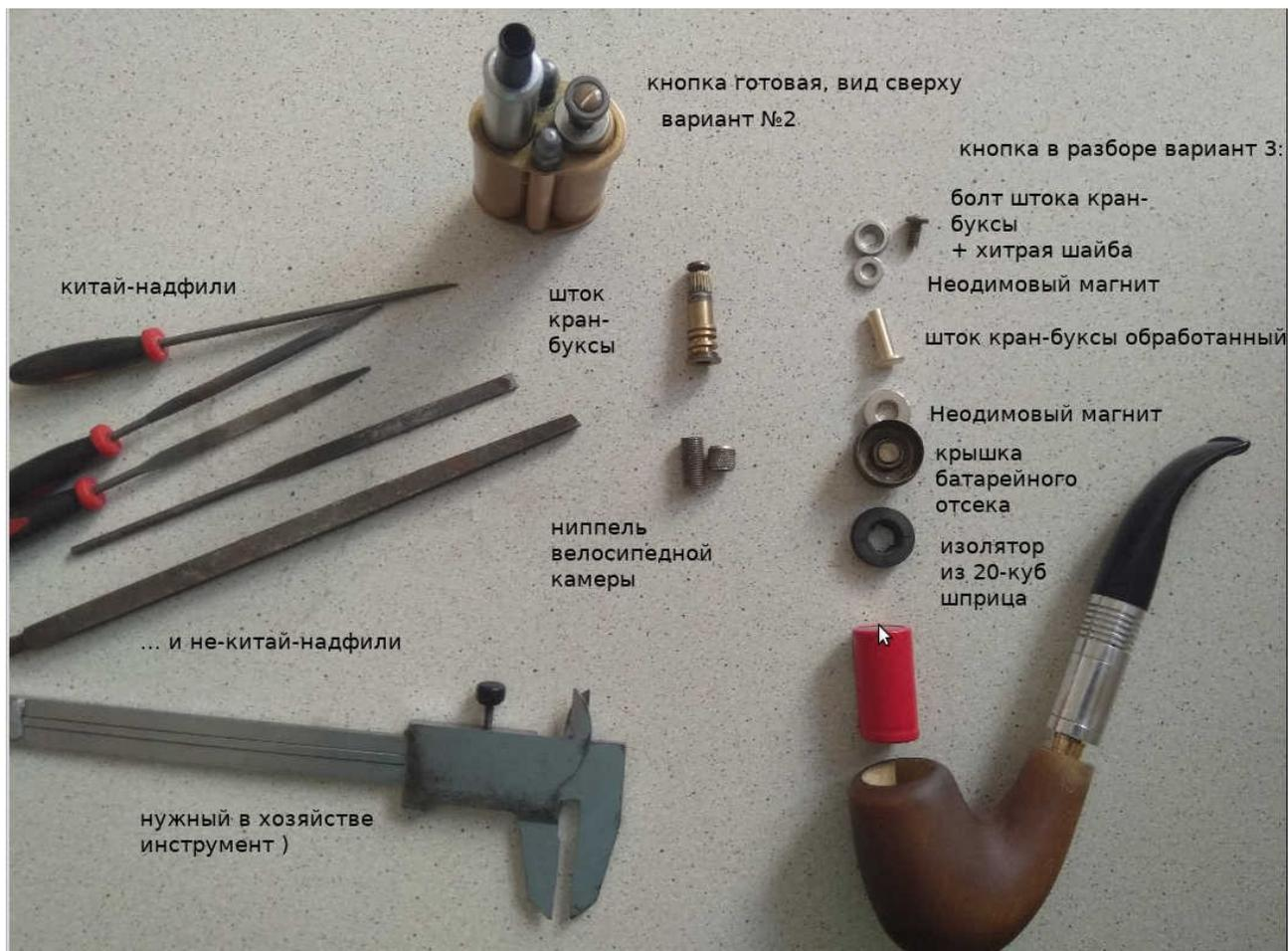
Ниппель велосипедной камеры ищем латунный с широким просветом. Гайки от этого же ниппеля. Либо две от разных (если тонкие), либо одну гайку можно распилить на две (если гайка длинная, как на фото)
