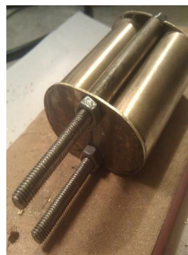
Верхние гайки только для примерки и подгонки. В конце заменяем их колпачковыми.
